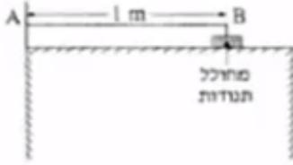
חוט AB, שאורכו 1m, קשור בקצהו B למחולל תנודות, ובקצהו A למוט קבוע (ראה תרשים).
